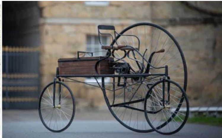
รถไฟฟ้าที่ขับเคลื่อนด้วยแบตเตอรี่และมอเตอร์ไฟฟ้า โดย Mr.Gustave Pierre Trouvé ชาวฝรั่งเศส ที่มา: https://www.thaiauto.or.th/
